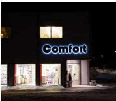
Fasadelogo i aluminium lakkert i rødt og sort. LED diodelys som lyser bakover. Logoen er 4 meter lang og 80 cm høy.
