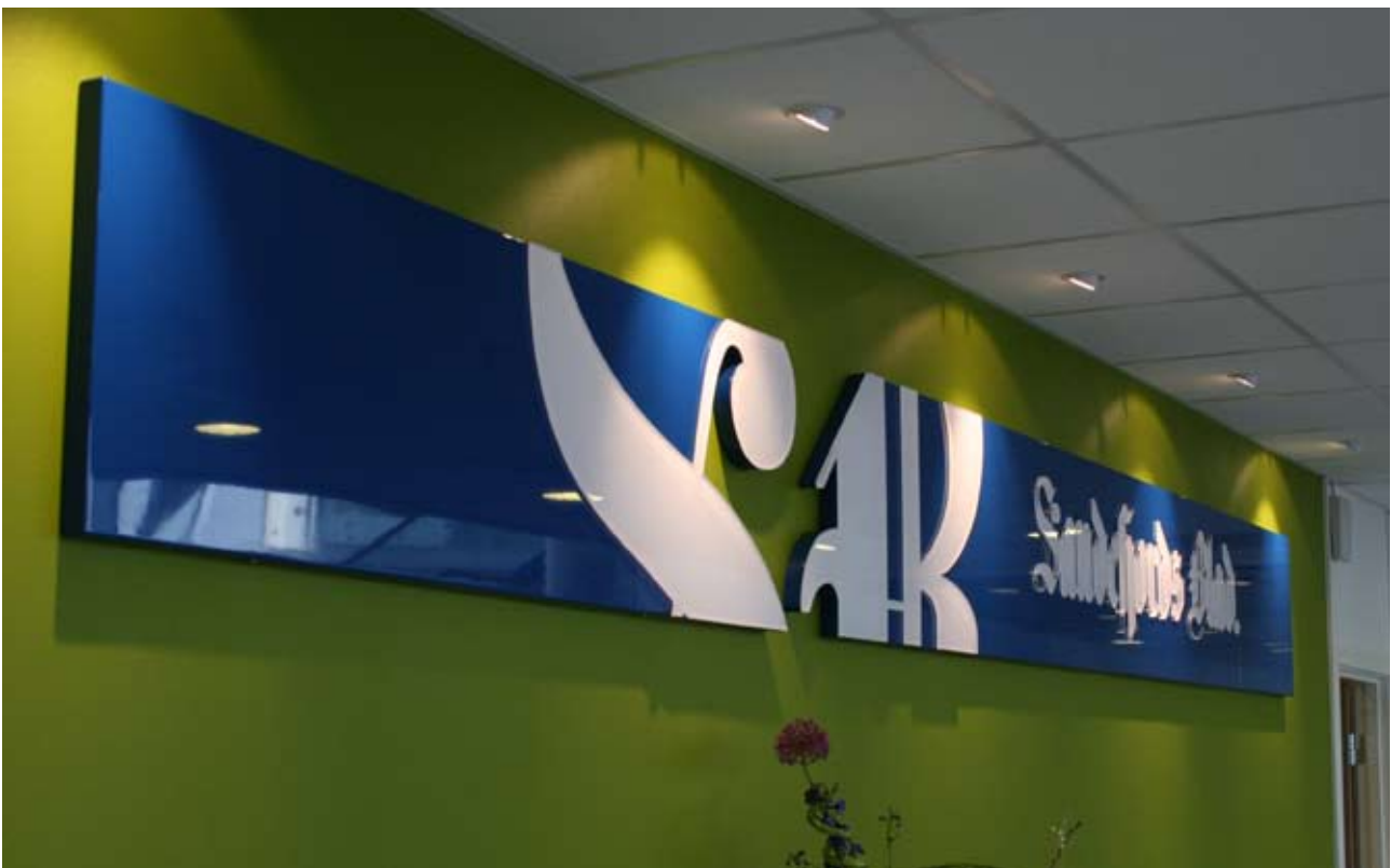
Firmalogo brukt som dekorasjon i resepsjonsområde. De blå aluminiumskassettene er utfrest og har deretter fått påveiset sarg og blitt lakkert i kundens logo-farge. På fronten av aluminiumskassettene er det montert logoer i klart plexiglass med hvit bakside. Skjult oppheng på veggen.
