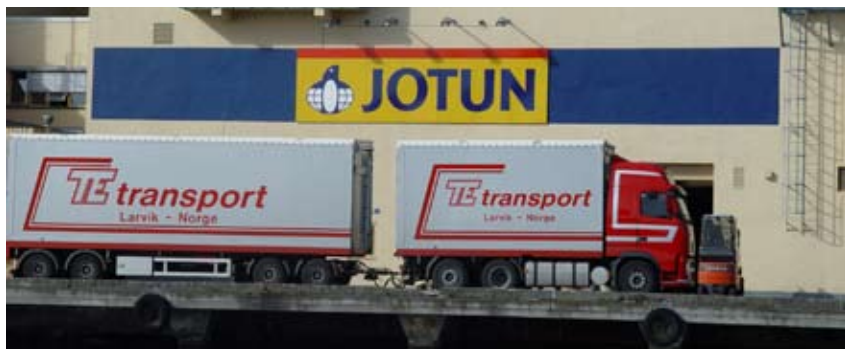
Fasadelogo for Jotun. Produsert i pulverlakkert aluminium med dekor i folie på fronten. Selve logoen er 860 cm lang og 270 cm høy.
