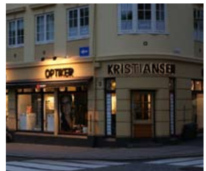
Kombinasjon av fasadebokstaver. «Kristiansen» i aluminiumsbokstaver med LED diodelys bakover montert på buet hjørne på fasaden. «Optiker», «Gullsmed» og «Urmaker» i fasadebokstaver i aluminium med indirekte belysning fra spotlights på arm.
