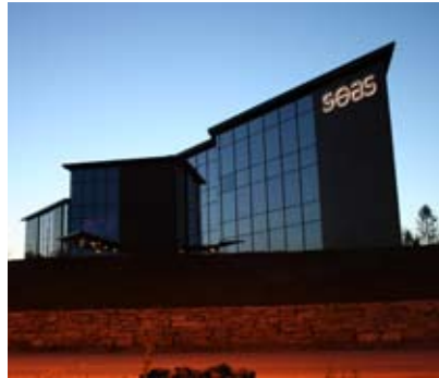
Fasadelogo i lakkert aluminium med front i børstet aluminium. LED diodelys bakover. Logoen er 4 meter lang og 1 meter høy.
