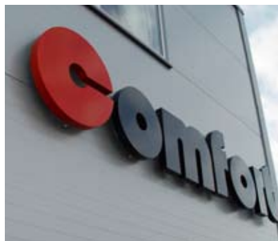
Fasadelogo i aluminium lakkert i rødt og sort. LED diodelys som lyser bakover. Logoen er 4 meter lang og 80 cm høy.
