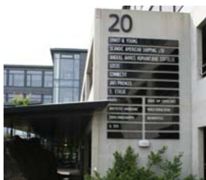
Leietakeroversikt i sortlakkerte aluminiums-kassetter. Foliedekor på fronten. Gatenummer «20» i lakkert aluminium med sarg.
