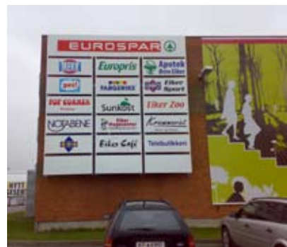
Leietakeroversikt på Eiker Senter i Hokksund. Aluminiumskassetter med logoene i utskåret folie på fronten. Total størrelse: 570 x 570 cm.
