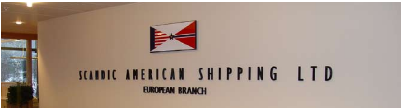
Firmalogo montert direkte på vegg i resepsjon. Firmanavnet er laserskåret, sort plexiglass. Flagget er også laserskåret og montert i flere lag med 3D-virkning.
