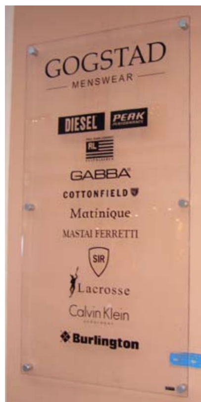
Skilt i 8 mm tykt plexiglass festet på fasaden med avstandsstykker i naturelloksert aluminium. Leverandøroversikt i utskåret folie.
