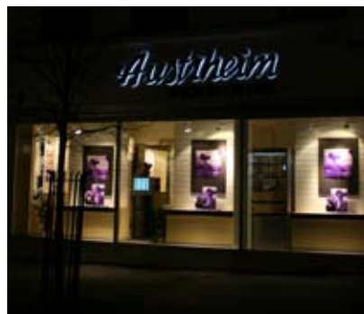
Fasadelogo med LED diodelys som lyser bakover.
